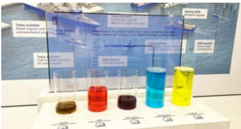
Kraftstoffdarstellung nach Mengenverbrauch bei selbem Wirkungsgrad. Von links nach rechts: Diesel, Gas, Methanol, Wasserstoff und Pure-E
